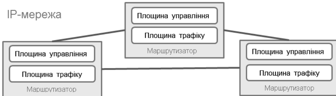
Рис. 1 – Спрощена архітектура IP-мережі
