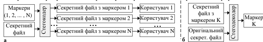
Рисунок 1 – Структурні схеми вбудовування (а) та вилучення (б) стегомаркерів
