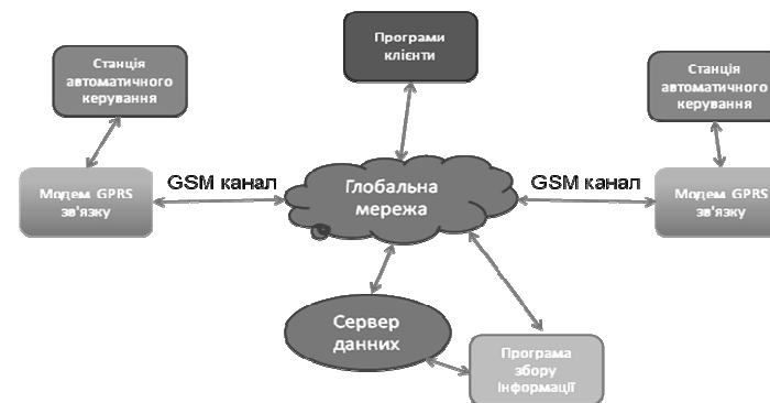
Рисунок 1 – Структурна схема системи диспетчеризації водопостачання з використанням бездротового зв’язку
